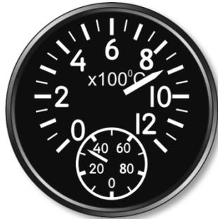
Abbildung 16: Triebwerkstemperaturanzeige16
