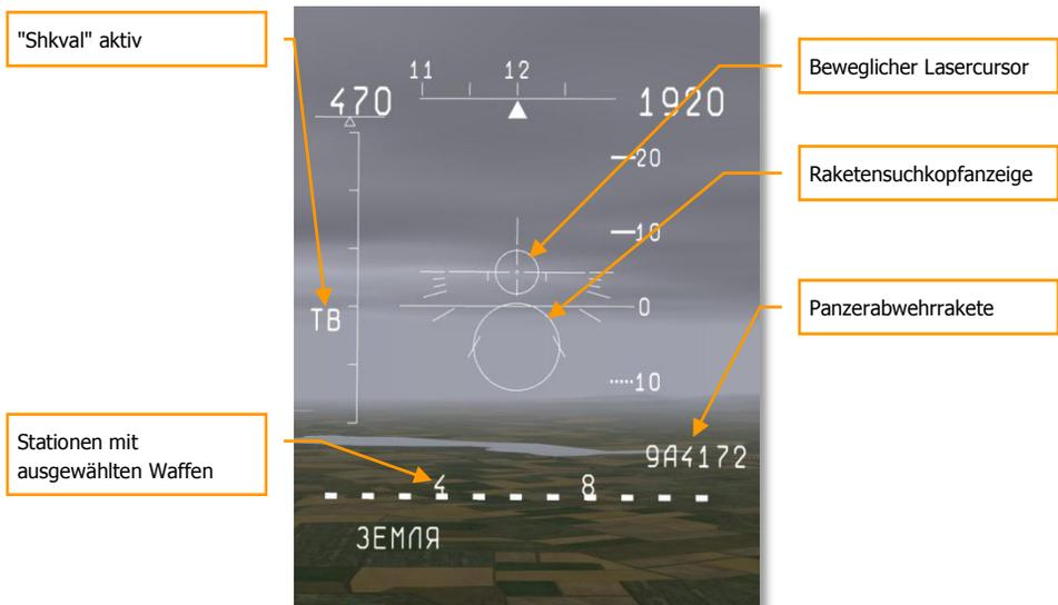
Abbildung 29: "Shkval" oder "Mercury" Zielsystem HUD Display29
