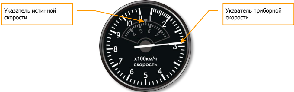
Рисунок 8: Указатель скорости самолета Су-25
