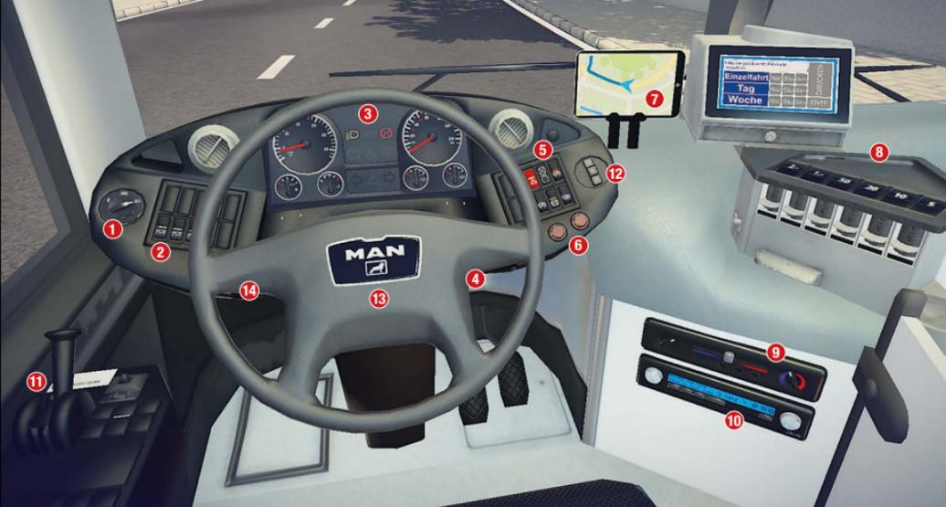
**1 Der Lichtschalter:** Aktiviere hier in 3 Stufen Standlicht, Fahrtlicht oder schalte das Licht nach einer Fahrt aus.
