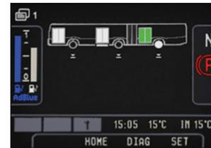
Für diese Busgeneration hat der Hersteller einen neuen Fahrerplatz gestaltet, der auf dem gewohnten VDV-Standard basiert. Enthalten ist auch wieder ein Infodisplay, das viele Rundanzeiger ersetzt, jedoch wurde dieses neu entwickelt und etwas kleiner gestaltet. Im Vergleich zum alten VDV-Cockpit hat man wieder etwas traditioneller Kontrollleuchten für die wichtigsten Funktionen eingebaut und vertraut nicht mehr so sehr auf das Display.
