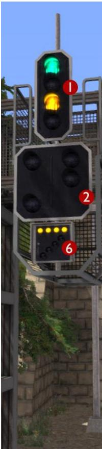
Ce signal combiné en approche d'une gare a un indicateur de voie occupée additionnel.
