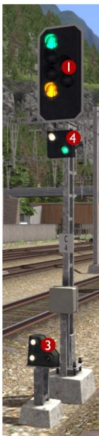
Voici un signal principal (Hauptsignal) qui affiche actuellement un Aspect 2 pour alerter le conducteur que la vitesse maximale autorisée après ce point est de 40 km/h.
