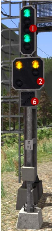
C'est un signal combiné qui affiche actuellement l'aspect 3 sur le panneau du signal principal. Il alerte le conducteur du fait que la vitesse maximale autorisée après ce point est de 60 km/h. Le panneau de signal à distance montre que le prochain signal à venir affiche un aspect 0 (Arrêt). La cible du signal avancé indique que le prochain signal à l'avant présente l'aspect 0 (Arrêt).
