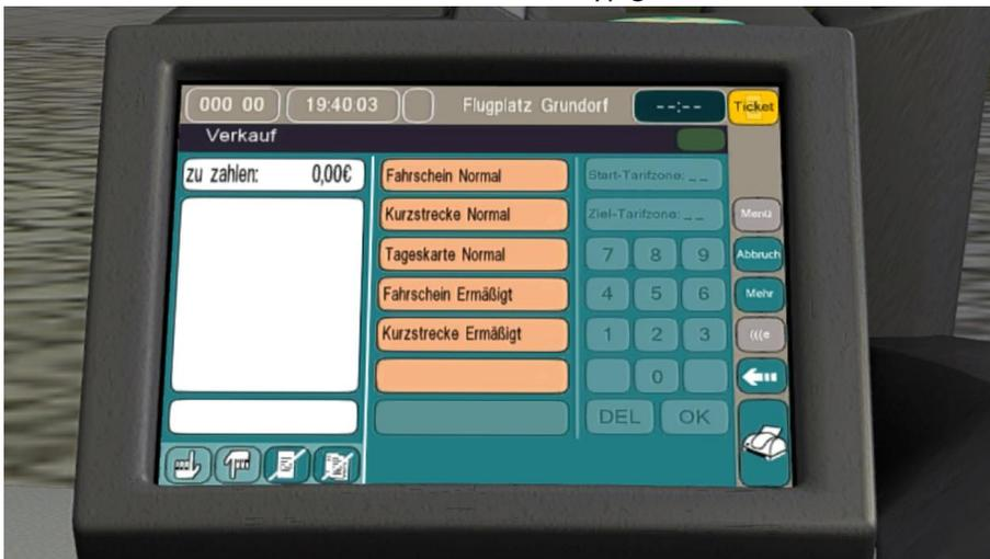
Nach der Auswahl des Kartentyps wird der Ticketpreis in der Linken spalte angezeigt. Bei einem klick auf den Drucker in der rechten, unteren Ecke wird der Ticketdruck eingeleitet. Weiterhin stehen die Tasten „Abbruch“ und „Zurück“ zur verfügung, deren funktion selbsterklärend ist.
