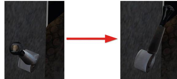
**WICHTIG:** Immer die Feststellbremse (Federspeicherbremse) betätigen, sobald der Bus abgestellt oder eine Pause eingelegt wird! Wir empfehlen Dir, auch die Feststellbremse zu verwenden, wenn Du länger vor einer roten Ampel stehst und nicht permanent das Bremspedal betätigen möchtest.
