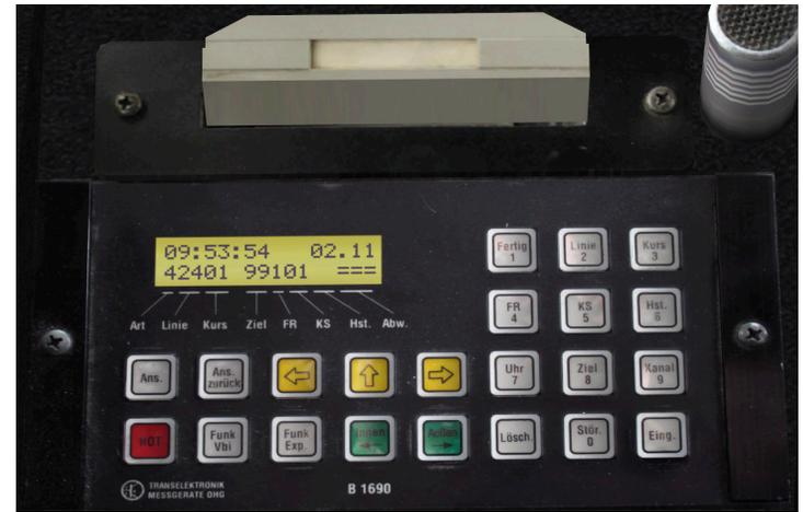
Zur Verwendung des IBIS-Geräts muss die **Boardspannung eingeschaltet** sein (siehe Kapitel „Den Bus in Betrieb nehmen“). Nach dem Einschalten des Stroms fährt das Gerät hoch: Es wird zuerst „**Kaltstart**“ sowie die Programmversion angezeigt:
