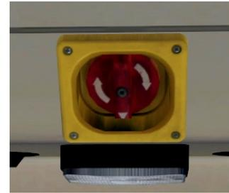
Beim NL 205 kann eine Türstörung behoben werden, indem man diese mit dem Türnothahn entlüftet. Danach kann man die Türen händisch bewegen und mit dem Türnothahn wieder in die Automatik versetzen. Sollte die Türstörung immer noch nicht behoben sein, so ist die betroffene Tür drucklos zu setzen, händisch zu schließen und von außen zu versperren. Durch das Versperren der Tür werden automatisch entsprechende Aufkleber auf die Türtransparente geklebt.
