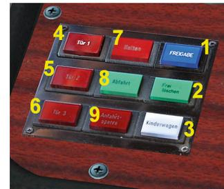
1. **Taster „Freigabe“:** Grundsätzlich wird immer dieser Taster betätigt, wenn man sich mit dem Bus im Stationsbereich befindet und den Fahrgastwechsel starten will. Durch Betätigung des Tasters öffnen jene Türen, bei denen ein Haltewunsch angemeldet wurde bzw. werden die Haltewunschknöpfe an der Außenseite des Busses aktiviert und die Fahrgäste an den Haltestellen können die Türen öffnen. Der Taster „Freigabe“ leuchtet blau, solange diese aktiv ist.
