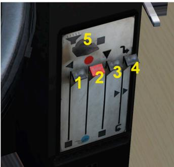
Der Bug-Akklimator wird durch den Regler auf der linken Fahrerplatzseite eingeschaltet. Die Lüfter haben 3 Geschwindigkeitsstufen. Unterhalb der Frontscheibe befindet sich das Frontgebläse. Je nach Stellung des rechten Hebels (4) gelangt über dieses Gebläse beheizte Frischluft (Stellung oben), ungeheizte Frischluft (Stellung Mitte) oder beheizte Umluft (Stellung unten) ins Wageninnere. Die Heizstärke kannst Du mit dem zweitlinken, roten Hebel (2) beeinflussen.
