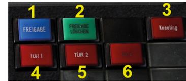
1. **Taster „Freigabe“:** Grundsätzlich wird immer dieser Taster betätigt, wenn man sich mit dem Bus im Stationsbereich befindet und den Fahrgastwechsel starten will. Durch Betätigung des Tasters öffnen jene Türen, bei denen ein Haltewunsch angemeldet wurde bzw. werden die Haltewunschknöpfe an der Außenseite des Busses aktiviert und die Fahrgäste an den Haltestellen können die Türen öffnen. Der Taster „Freigabe“ leuchtet blau, solange diese aktiv ist.
