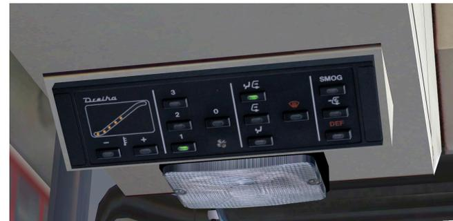
Die Fahrzeuge werden über eine Warmwasserheizung beheizt, bei der das Kühlwasser des Motors zur Fahrgastraumheizung verwendet wird.
