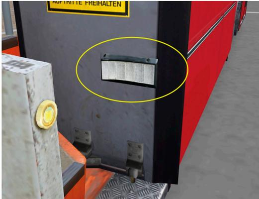
Eine Türstörung tritt vor allem bei schlechten Witterungsbedingungen auf, wenn die Reflektoren verschmutzen und dadurch die Lichtschranken unterbrochen werden. Dies äußert sich darin, dass die Tür beim Schließvorgang wieder aufspringt und sich nicht komplett schließen lässt. In diesem Fall musst Du das Fahrzeug sichern, Dich von dieser Tür begeben und den Schmutz von dem betroffenen Reflektor wischen. Danach sollte die Tür wieder ordnungsgemäß funktionieren.
