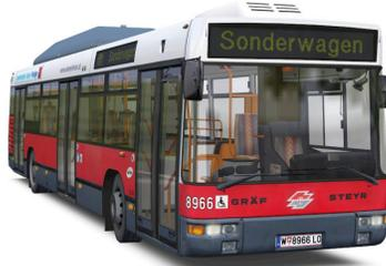
Der NL 205 M12 (= „Niederflur-Linienbus, 205 PS und 12m Länge“) ist eine österreichische Spezialkonstruktion von den Firmen ÖAF-Gräf & Stift und Steyr-Daimler-Puch für die Wiener Verkehrsbetriebe.
