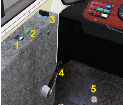
1. ASR-Taster: Die ASR-Funktion wird abgeschaltet → die Kontrollleuchte leuchtet auf
