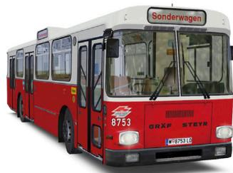
Der LU 200 M11 (= „Linienbus mit Unterflurmotor, 200 PS und 11m Länge“) ist eine österreichische Spezialkonstruktion von den Firmen ÖAF-Gräf & Stift und Steyr-Daimler-Puch für die Wiener Verkehrsbetriebe. Der Wagenkasten ist dem deutschen VÖV-Standard-Stadtlinienbus der ersten Generation angeglichen, hat aber entsprechend Wiener Gepflogenheiten eine dritte Einstiegstür im Heckteil. Für den Antrieb wird ein Ottomotor für Flüssiggasbetrieb verwendet.
