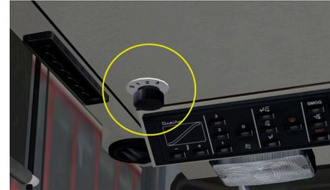
Alle Fahrzeuge der Type NL 205 sind ab Betriebsnummer 8950 mit einer Fahrerklimaanlage ausgestattet. Mit dem Drehknopf kannst Du 3 Stufen wählen und in Stufe 0 ausschalten.
