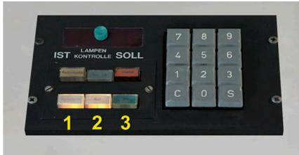
Das Rollbandsteuerungsgerät ist notwendig für die Bedienung der motorisierten Rollbänder vorne und auf der Seite des Busses. Dazu gibt es zwei Betriebsmodi, die zur Verfügung stehen:
