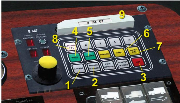
1. Ansage: Mit dieser Taste kann die Ansage per Hand fortgeschaltet werden (alternativ kann der linke Fußtaster betätigt werden – [Q])
