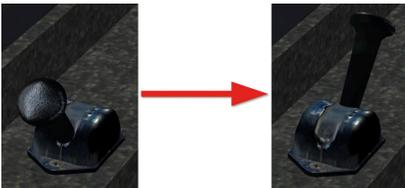
**WICHTIG:** Immer die Feststellbremse (Federspeicherbremse) betätigen, sobald der Bus abgestellt oder eine Pause eingelegt wird! Wir empfehlen Dir, auch die Feststellbremse zu verwenden, wenn Du länger vor einer roten Ampel stehst und nicht permanent das Bremspedal betätigen möchtest. Außerdem wird die Niveauregulierung beim NL 205 durch Betätigen der Feststellbremse aktiviert – benutze diese also immer dann, wenn der Niveauregulierung durchgeföhrt werden muss.
