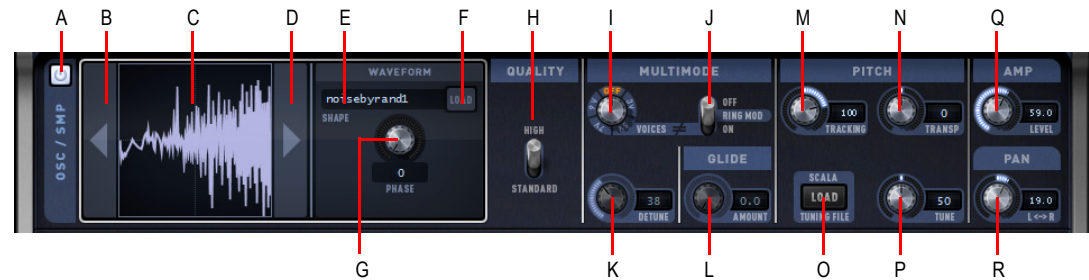
A. Element Power B. Previous Waveform C. Waveform display D. Next Waveform E. Name F. Load Waveform G. Phase H. Quality I. MultiMode Voices J. RingMod K. Detune L. Glide M. Tracking N. Transpose O. Scala tuning P. Tune Q. Level R. Pan
