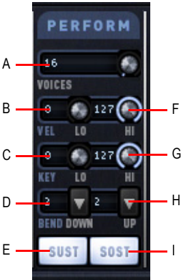
A. Voices B. Low Velocity C. Low Key D. Bend Down E. Sustain F. High Velocity G. High Key H. Bend Up I. Sostenido
